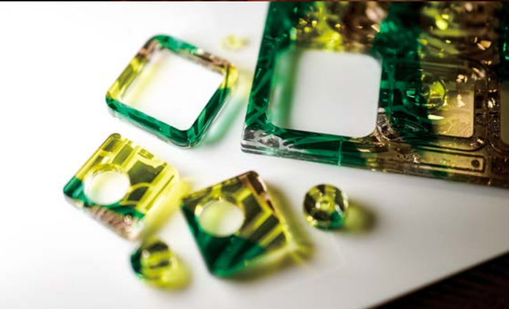
データをもとに、レーザーカッターでアクセサリを切り出す。余った部分は再度アクリルと混ぜ合わせて有効活用する
