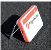
ボールの後方2.1mに置き、飛距離、ヘッドスピード、ボールスピード、スマッシュファクター、スピンなどが計測できる。
